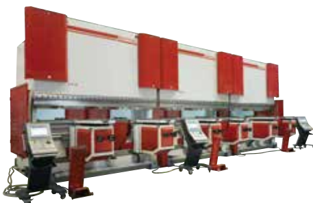
タンデム(3台連結) 全長9300mm/総加圧トン数1320トン 工場搬入にあわせて小型機で連結した例
