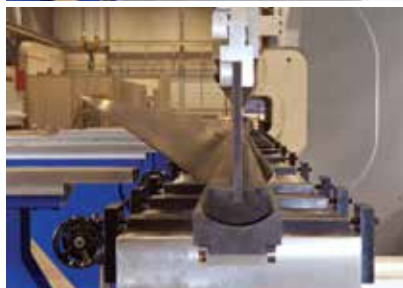
タンデム(2台連結) 全長14200mm/総加圧トン数1400トン
