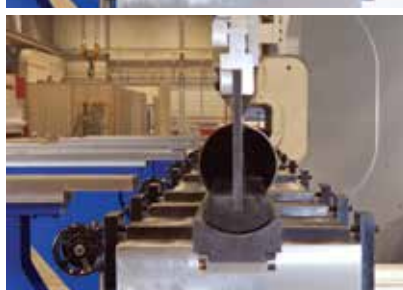
タンデム(2台連結) 全長12200mm/総加圧トン数880トン
