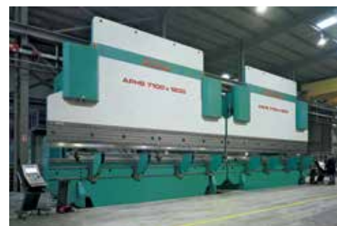
タンデム(2台連結) 全長14200mm/総加圧トン数2400トン
