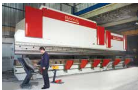
ユニークなタンデム 異なるサイズのベンダーの連結を実現 写真は8m+4mと800トン+440トンの組み合わせの実例
