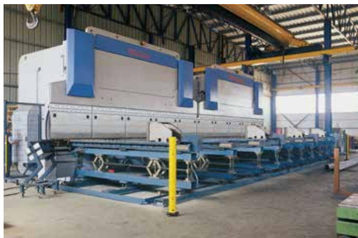
タンデム(2台連結) 全長14200mm/総加圧トン数1400トン
