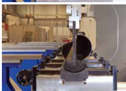
ユニークなタンデム 異なるサイズのベンダーの連結を実現 写真は8m+4mと800トン+440トンの組み合わせの実例
