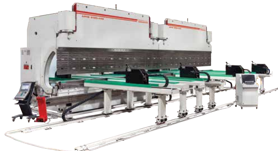
タンデム(2台連結) 全長12200mm/総加圧トン数880トン
