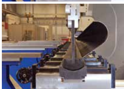
8100mm/1000トン ロール曲げ 材質:MS 板厚:5mm 長さ:8m R:225
