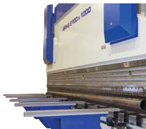
8100mm/1000トン ロール曲げ 材質:MS 板厚:5mm 長さ:8m R:225
